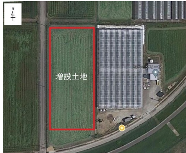
図5 既設フェンロー型ハウス(23a)に隣接した水田あとに同型ハウス(32a)を増設 (写真: Google マップより)
