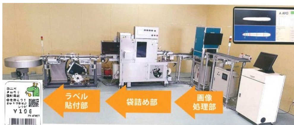
図12 個包装を行う袋詰め選果機とラベル例
