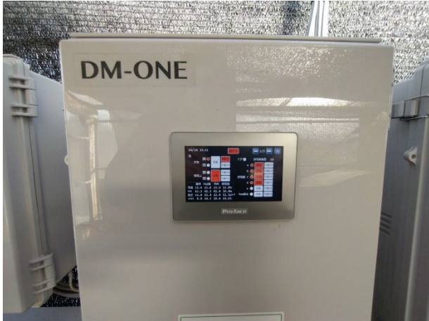
図10 統合環境制御装置（DM-ONE）。タッチパネル画面は強制換気装置とミスト噴霧装置の動作画面（A農園向け仕様）。スマートフォンからのリアルタイム操作とモニタリングも可能。
