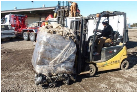
積み込み作業の様子 フォークリフトで 木製パレットの上でまとめて保管してい た廃農ビ梱包を近くに運ぶ。
