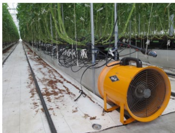
(b) 外気導入効果を試験中。左写真の妻面内に設置したファンで外気導入を促進し、右写真のダクトファンで温室中央方向へ送風(次世代施設園芸埼玉県拠点)
