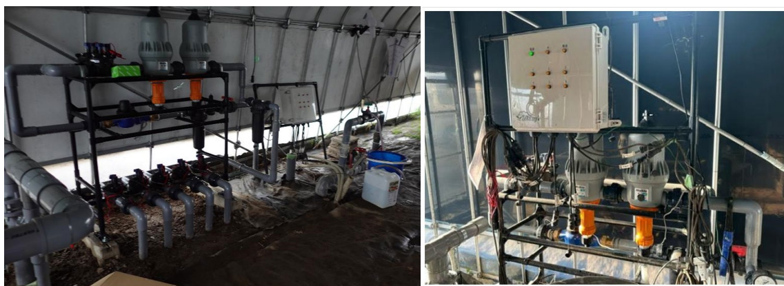
図7 左: 液肥混入機、右: 灌水コントローラ(ゼロアグリ)
