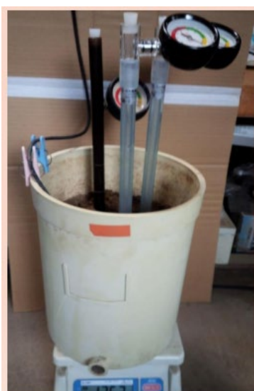
図 6 土壌水分センサーの性能試験
