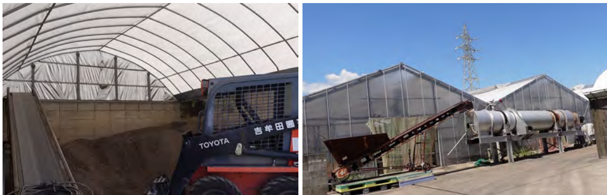
図12 クリークしゅんせつ土を焼成した培地材料(左)と焼成装置(右)
