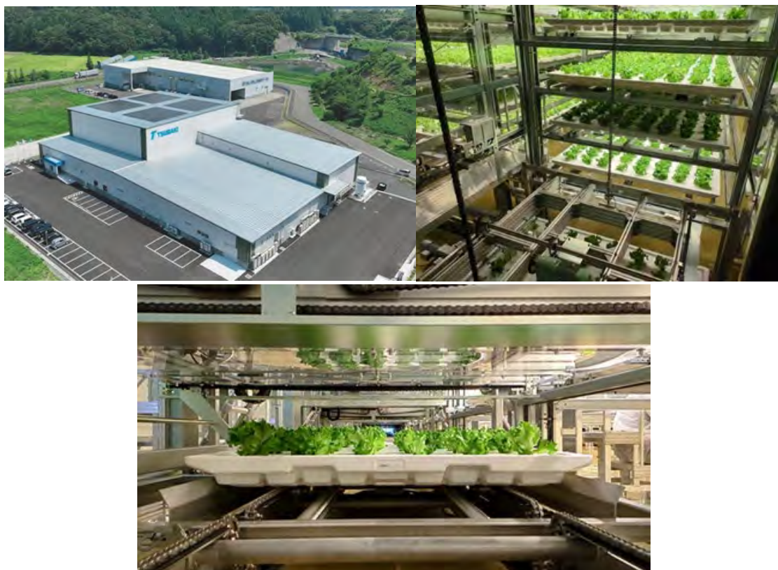
図4 椿本チエイン福井美浜工場の外観と内部の栽培システム 椿本チエインWebサイトより
