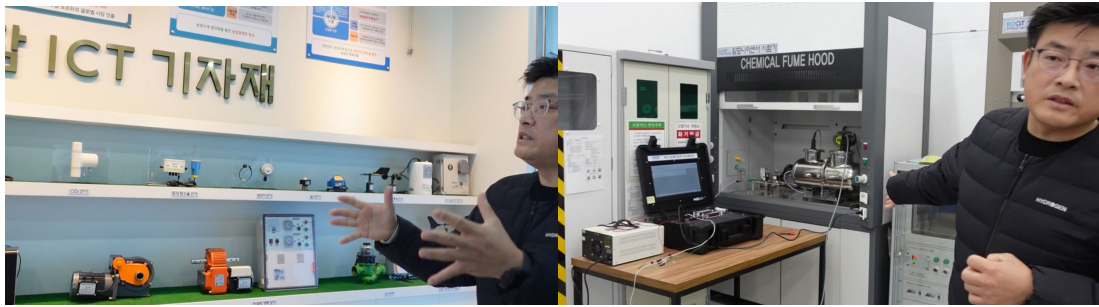
展示物（左：ICT機器として分類された温室の計測制御や養液供給等を行う製品類）とアンモニアセンサー検定設備（右：畜産施設臭気測定用途）
