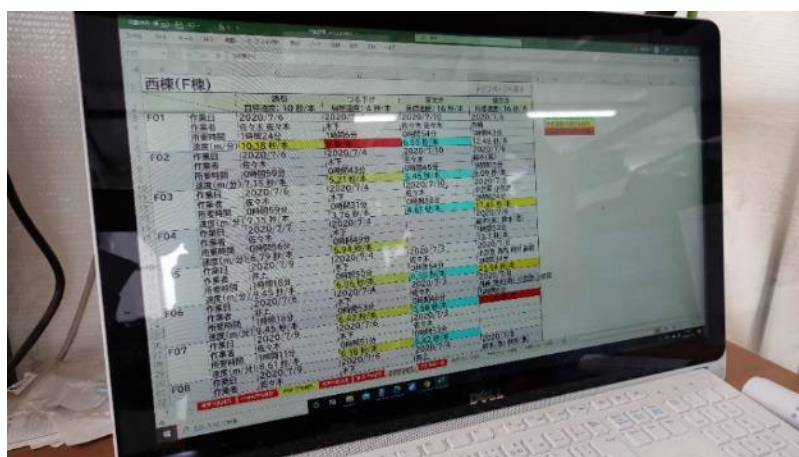
(Excel マクロとデータベースリンク機能により自社開発した作業管理システム、画面は当該ハウスの作業進捗状況、縦：作業エリア、横：作業種別、色分けで進捗を表示)
