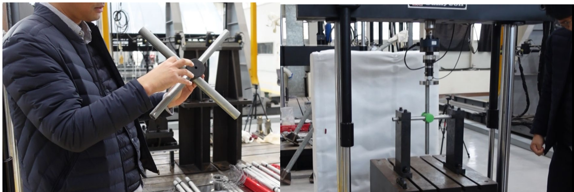
開発中のFRP製継手（左）と強度試験設備（右）
