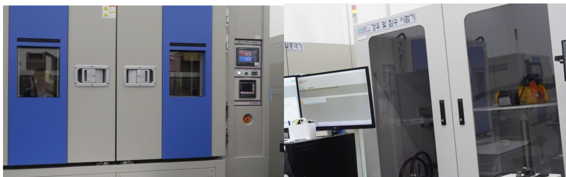
熱衝撃（急熱・急冷）による検証設備（左：熱帯地域への輸出時等の検証用途）と降雨による検証設備（右：自然災害に対する検証用途）
