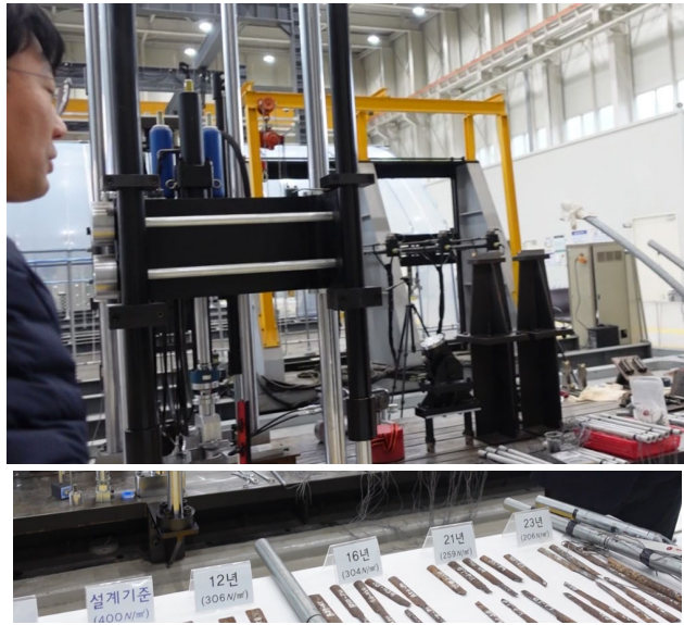
パイプの強度試験設備（上：引っ張り強度、変形等）とサイズ別のパイプサンプル（下）
