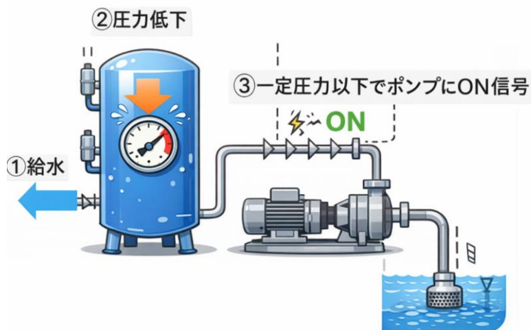
(参考) 圧力タンクの構造と機能イメージ図
