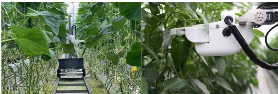
図3 AGRISTのキュウリ、ピーマンの収穫機械 AGRIST Webサイトより
