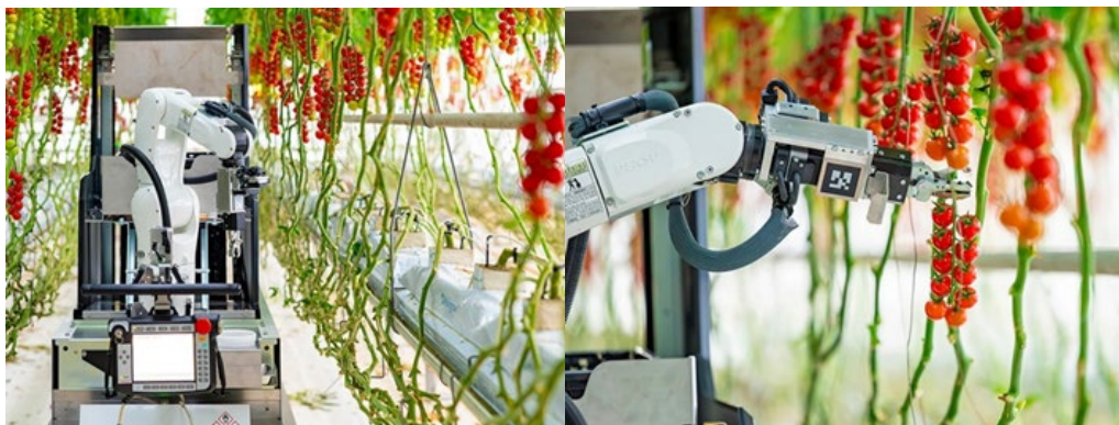
図1 全自動収穫ロボット「Artemy(アーテミー)」DENSO Webサイトより
