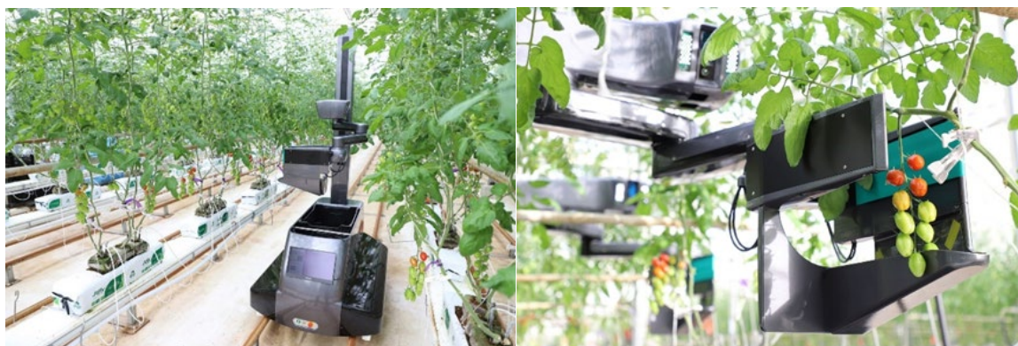
図2 inaho社のミニトマト自動収穫機 inaho Webサイトより
