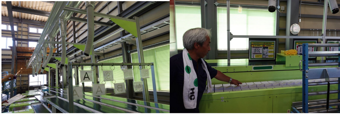
図5 形状選果によるキュウリ選果装置
