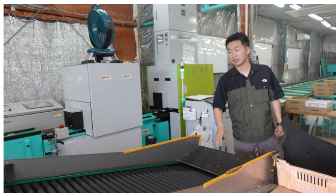
図10 選果装置カメラ部(奥左)と重量・糖度検知部(奥中)、西内亘氏
